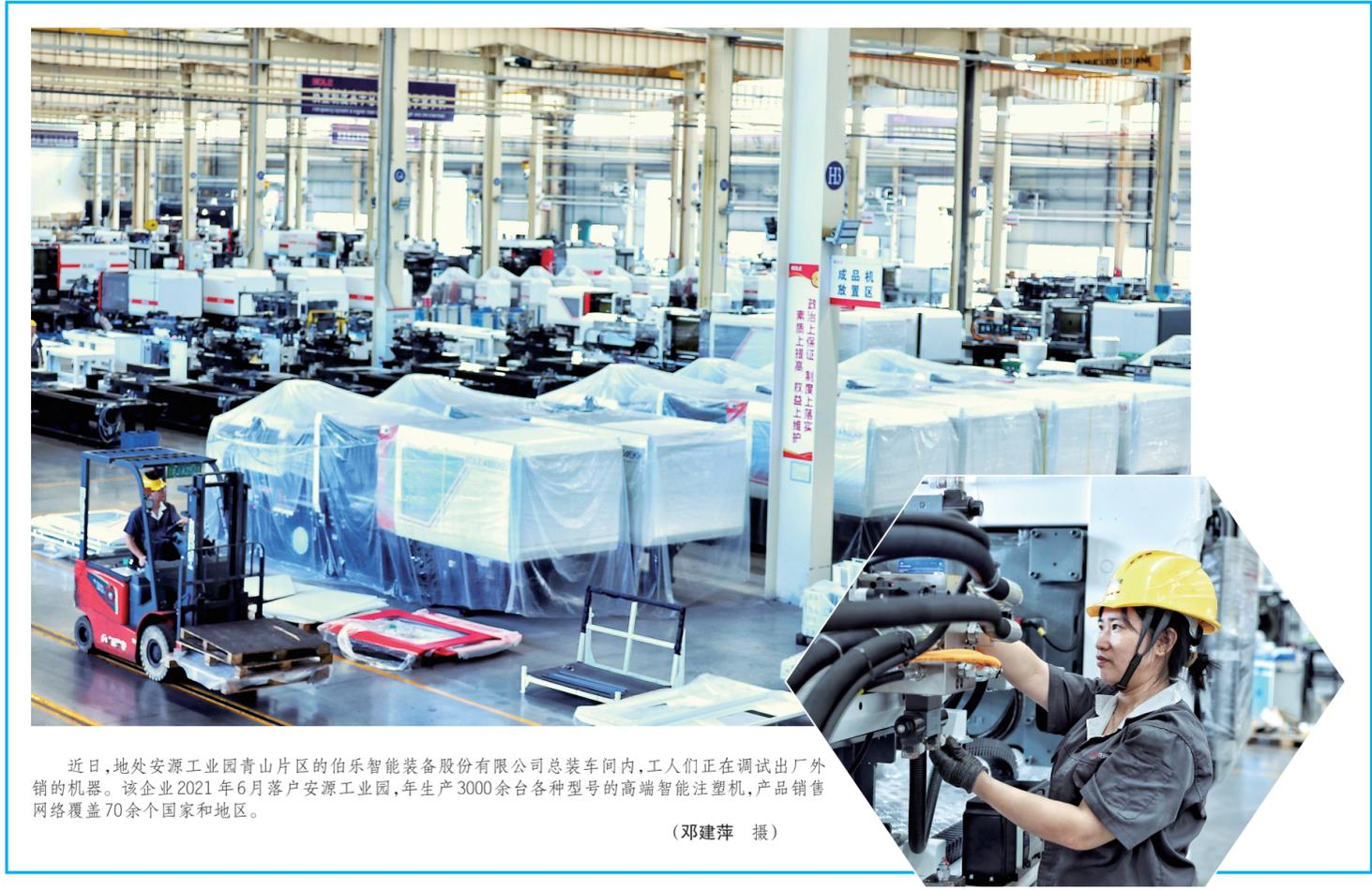
近日，地处安源工业园青山片区的伯乐智能装备股份有限公司总装车间内，工人们正在调试出厂外销的机器。该企业2021年6月落户安源工业园，年生产3000余台各种型号的高端智能注塑机，产品销售网络覆盖70余个国家和地区。
